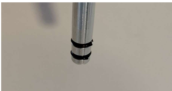
Poškozený O kroužek
